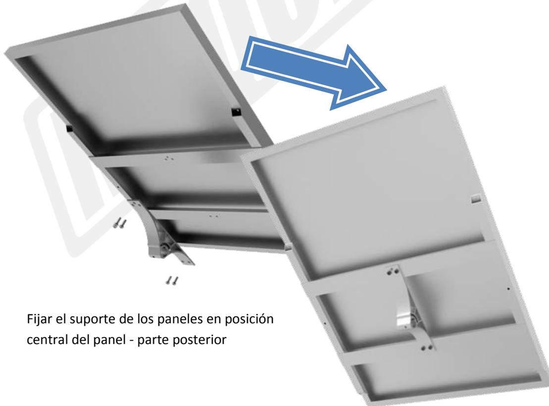
Fijar el soporte de los paneles en posición central del panel - parte posterior
