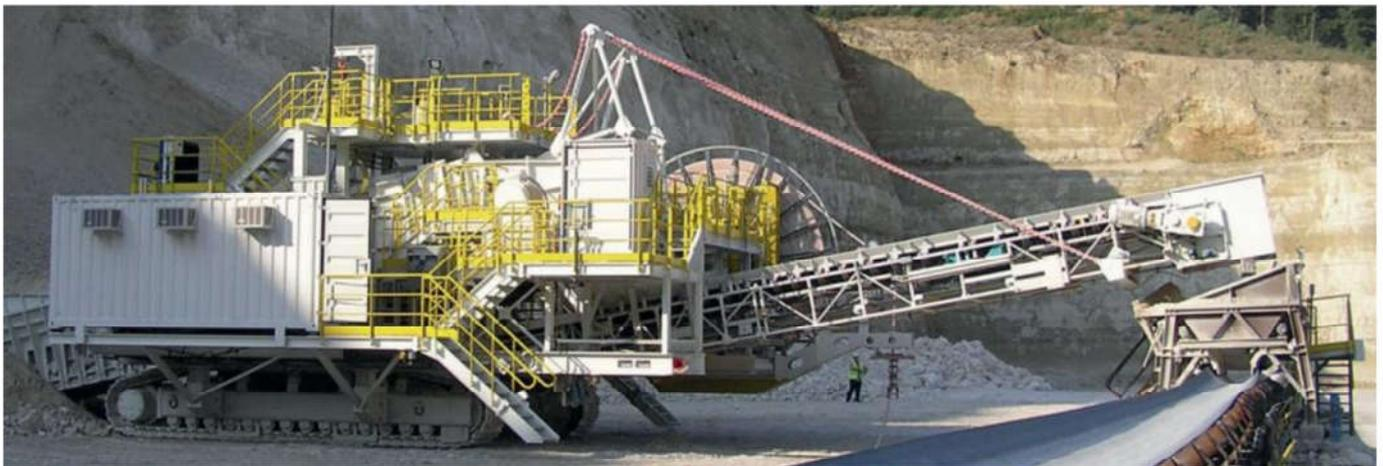
Ejemplo: Trituradora de Rodillos de Impacto montada sobre orugas
